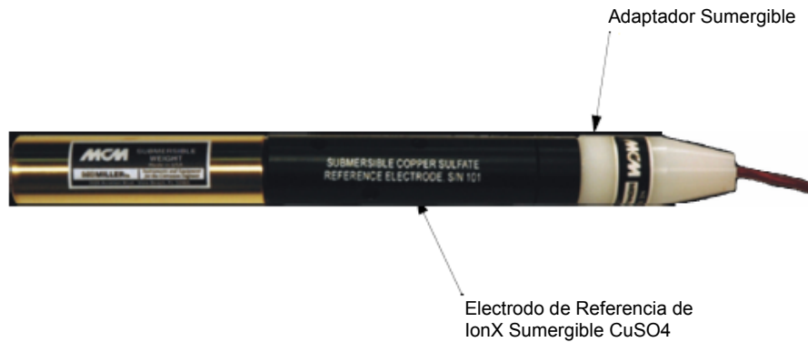
Figura A. 2. Electrodo de referencia IonX sumergible CuSO 4 con adaptador
